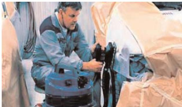
*Un aspiratore industriale carrellato collegato ad un utensile elettrico con kit di aspirazione è la soluzione ideale per piccoli lavori di carteggiatura e smerigliatura.*
